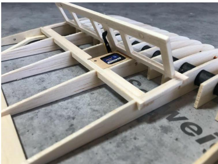
Sollte unsere Lösung für die Klappenöffnung verwendet werden, wird eine Servoarmverlängerung benötigt. Für die Servohebel empfehlen wir unsere GFK Verlängerung, die zusammen mit den passenden Servorahmen als Zubehör erhältlich ist. Für die Funktionseise haben wir ebenfalls ein Video:
