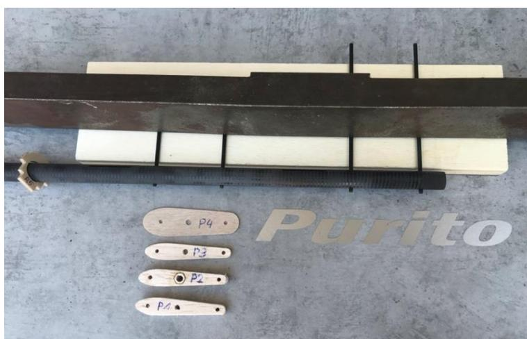
Das Pylonteil P1 kann jetzt aufgesteckt und verklebt werden. Beim Bauteil P2 darauf achten, dass die M3 Mutter nach unten zeigt. Bauteil P2 und P3 ebenfalls aufstecken und verkleben. Nur das Bauteil P4 darf noch nicht verklebt werden, da dies erst später mit dem Höhenruder geschieht. Die Kohlestäbe, die aus dem Pylon für das Höhenruder oben
