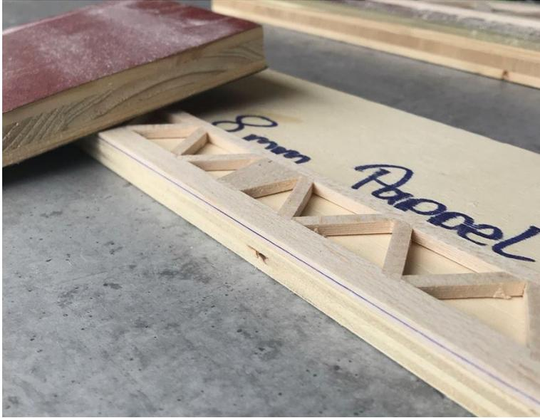
die Schleifplatte auf der Endleiste des Leitwerks und der Tischkante aufliegt. So schleifen wir die Endleiste bis auf unsere Hilfslinie von beiden Seiten (ca. 1mm) spitz zu.
