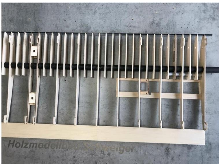
Das Bauteil A2V befindet sich auf dem 8mm Balsabrett und wird unter das Sperrholzteil A1V geklebt sowie bündig gestochen. Tipp: einen Bohrer mit dem Durchmesser von 5mm durch die Balsaklötze A2V beim Verkleben stecken, damit die Löcher genau übereinander liegen.
