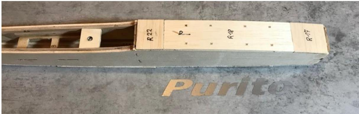
Das Sperrholzteil R23 wird innen in die Kabinenhaube zur Rumpfspitze mittig eingeklebt und dient dabei als Zunge. Das Balsateil R21 wird an das Ende der Kabinenhaube zwischen die Sperrholzstreifen geklebt. Einen Stahldraht in L-Form biegen und zusammen in einen Bowdenzug in die Innenseite der Kabinenhaube als Verschluss einkleben.
