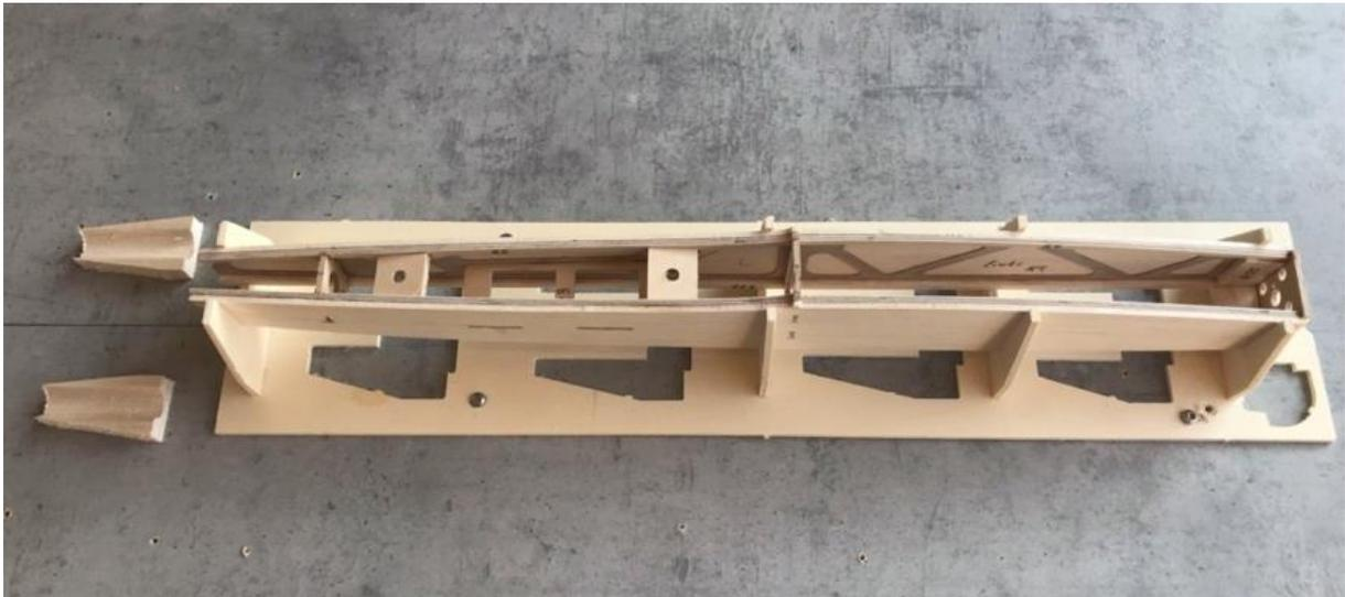
Tipp hier: wir verschrauben die Rumpfhelling mit unserem Baubrett. Somit ist gewährleistet, dass sie sauber aufliegt und der Rumpf verzugsfrei aufgebaut werden kann. Wenn alle Teile ordentlich in der Helling zusammenpassen, können Sie verklebt werden. Wichtig hier: der Spant R5 darf noch nicht mit verklebt werden. Genauso werden die Teile der Flächenverschraubung R11 und R12 nur in die dafür vorgesehenen Schlitze gesteckt, aber noch nicht verklebt.
