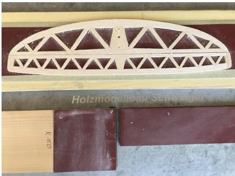
Für das Verschleifen des Leitwerks vorab noch ein Tipp: Wir kleben ein Schleifpapier über die gesamte Länge des Leitwerks auf eine Holzlatte. Darauf wird im Anschluss das Leitwerk, wie im Bild zu sehen ist, gelegt. Dadurch verrutscht das Leitwerk nicht mehr und kann jetzt mit einer weiteren Schleiflatte plan, leicht überschleifen werden. Somit können Kleberückstände von der Oberfläche entfernt werden.
