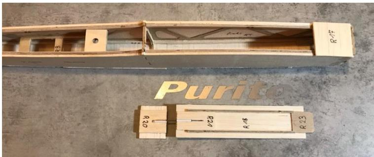
Anschließend wird auf die Rumpfbeplankung R22 das Teil R20 mittig geklebt und zusammen mit der Kabinenhaube in der Kabinenhaubenöffnung im Rumpf eingepasst.
