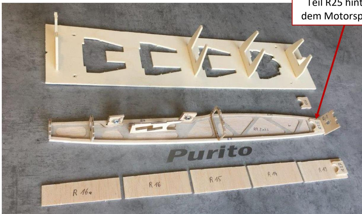
Teil R25 hinter dem Motorspant
