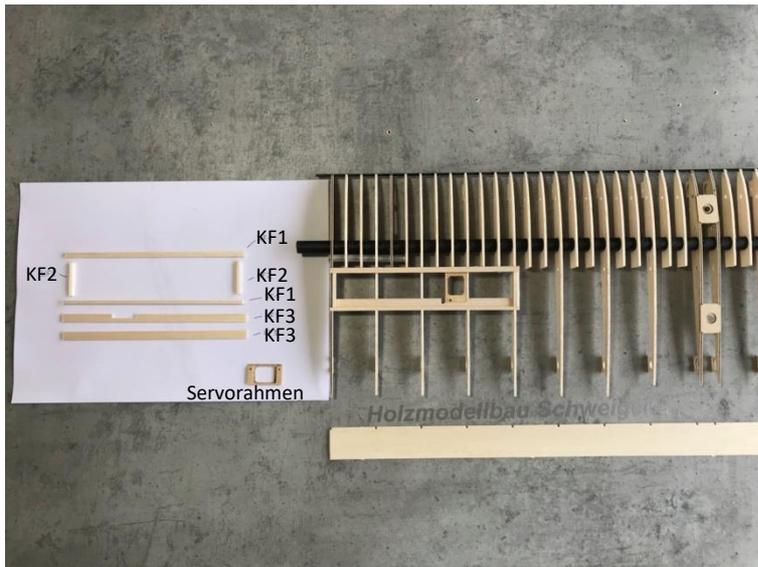
Der nächste Arbeitsschritt ist die Umrandung für die Klappen in der Fläche. Es werden die Teile KF1-KF2 aus dem 3mm, und die beiden Leisten KF3 aus dem 2mm Balsabrett benötigt. KF3 ist auf dem Balsabrett der Rippen (Teil A) zu finden. Zu beachten ist hier, dass es von KF3 zwei verschiedene Ausführungen gibt: einmal mit der Ausfräsung für einen Servorahmen und einmal ohne die Ausfräsung. Die Teile werden in die Fläche in die dafür vorgesehenen
