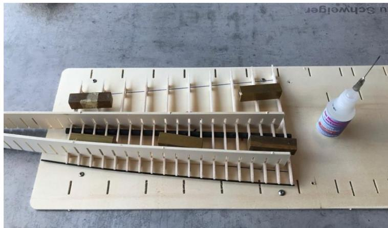
Auf dem Bild sind die benötigten Teile zu sehen: Grundplatte, passende Rippen für Teil C, Randbogen, 5 Grad Anschlag, Endleiste, Kamm, 7mm CFK Rohr (Holm) und das 2mm CFK Rohr (Nasenleiste).
